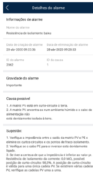
Figura E-1 Detalhes do alarme
